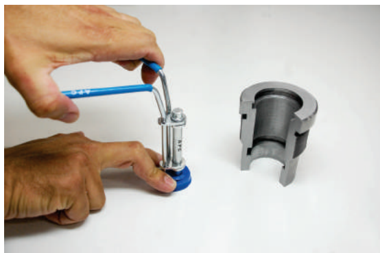
3) Posicionando a gaxeta e travando o alicate
